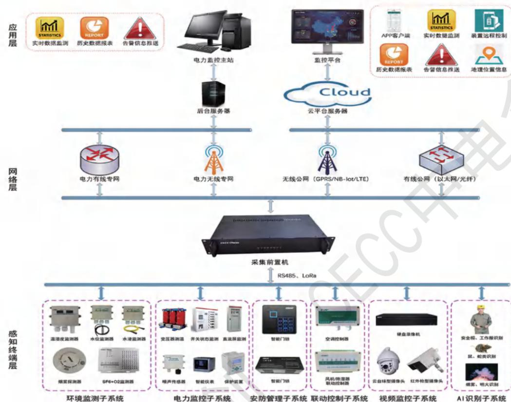
配电站房辅助监控系统以监控主机为基础，以“智能感知和智能控制”为核心。实现配电站房动力环境信息，安全门禁信息，视频监控信息、低压设备运行环境参数等信息采集、逻辑判断处理，通过联动灯光、风机、除湿机等设备实现配电站房动态环控，联动视频、安消防、报警装置实现配电站房安全监控，通过监控系统实现电力监控及AI识别功能。预留通讯接口，可接入电网配电内网系统。
